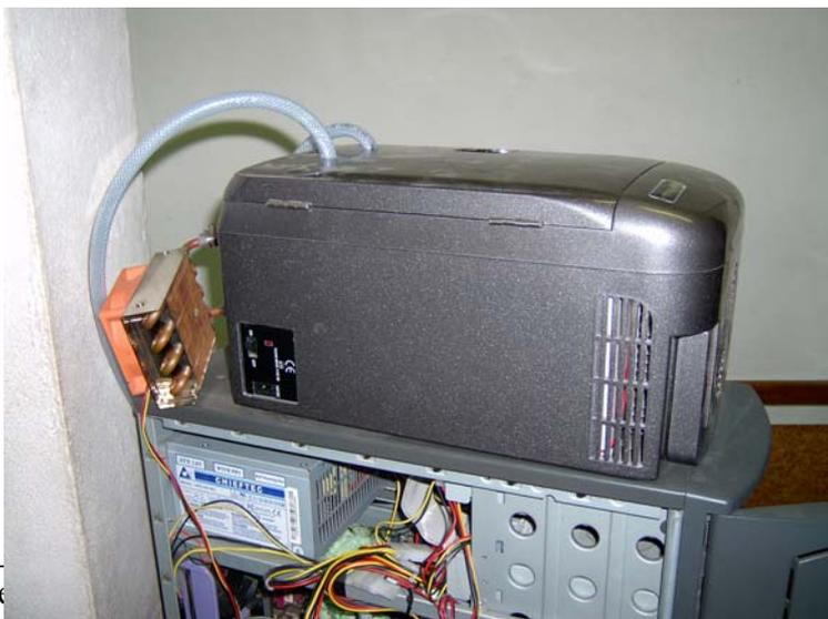
Mini-frigorífico e radiador em cobre montados sobre a caixa do computador.
