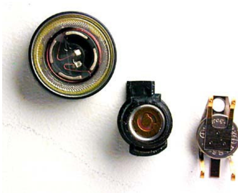
Microfone, auscultador e bateria backup
