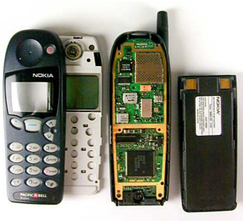
As componentes de um telemóvel
