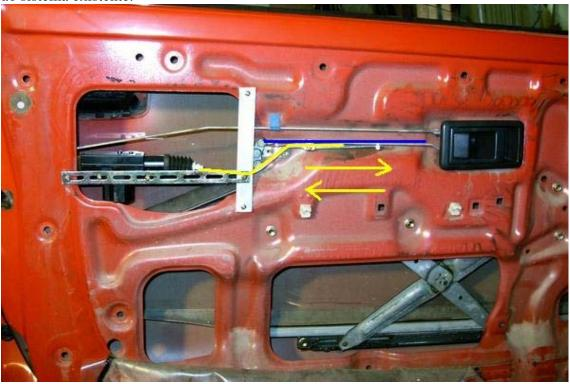
Como este carro não tinha nenhuma instalação eléctrica, nem passa-cabos, foi necessário colocar. Foram utilizados passa-cabos iguais ao existente na porta da mala.
