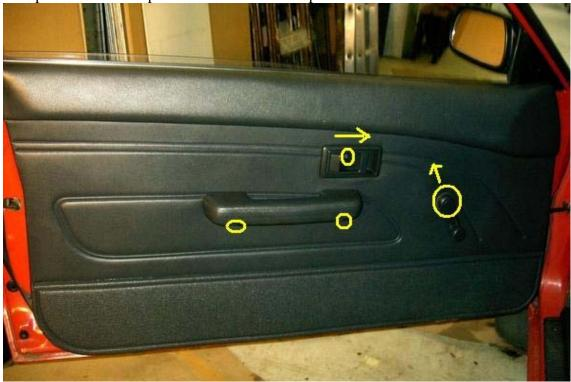
O puxador da porta tem apenas dois parafusos. Quanto ao destrancador da porta, depois de retirar o parafuso, é necessário empurrar no sentido da seta. O manípulo do elevador do vidro tem uma mola que deve ser retirada no sentido indicado na imagem.
