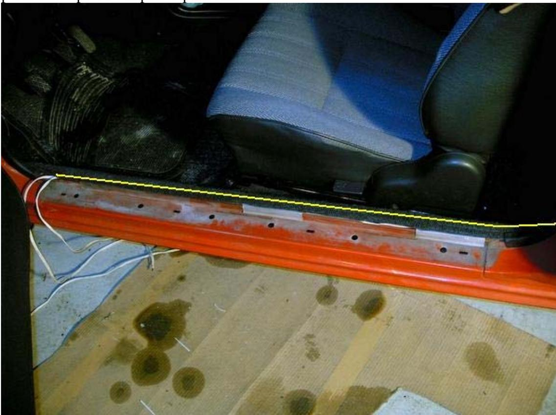
Poderia ter utilizado os fios que existem perto dos fusíveis, mas como também irei montar um fecho centralizado e um alarme, achei melhor ir buscar a energia directamente à bateria, utilizando uma passagem já existente.
