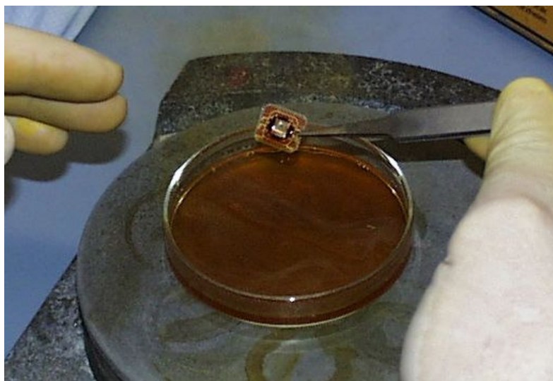
Ácido Nítrico (>98% NHO 3 ) dissolve a embalagem sem afectar o chip
